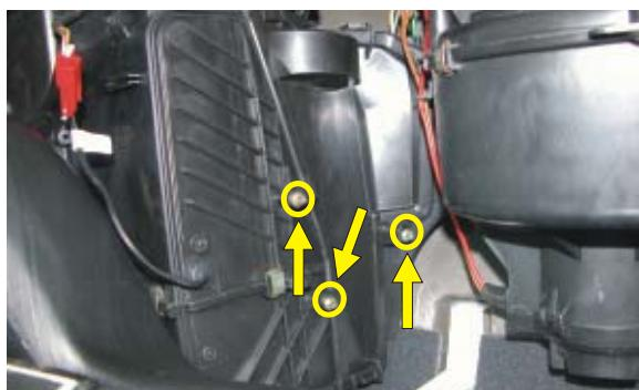
**(PL)** Odkręcić wkręty pokrywy filtra, usunąć pokrywę
